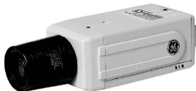
KTC-2000DNP 是一款高分辨率、昼夜转换型摄像机。在彩色模式中，可以提供 480 线的分辨率，在黑白模式中，可以提供 570 线的分辨率。在彩色模式下的最低照度为 0.1lux，黑白模式下的最低照度为 0.01lux。
